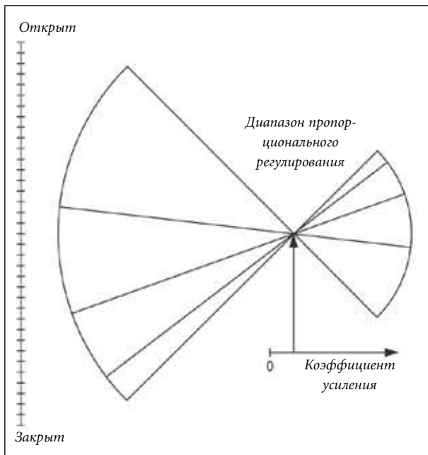
Малому коэффициенту усиления соответствует широкий диапазон пропорционального регулирования
