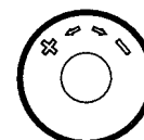
Ручная установка расчетной степени открытия клапана 2К.
