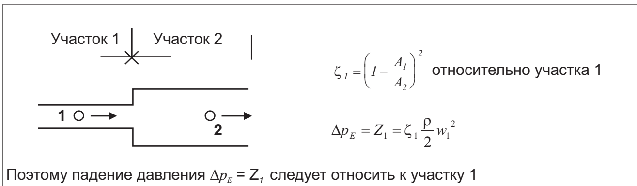
Рис. 1-5. Местное сопротивление - расширение трубы
