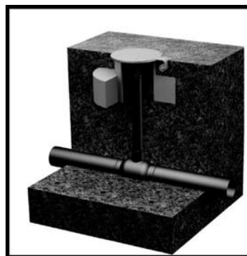
Подземный кран, установка под ковер
